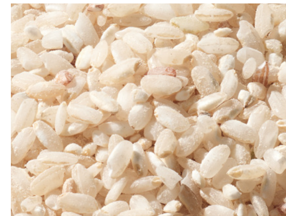
↑ Zwischenprodukt: Weißreis nach Verticone 1. Pass
