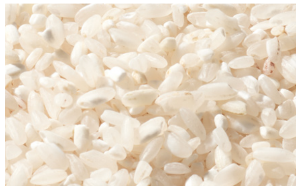
↑ Eingangsprodukt: Grober Bruchreis nach dem Plansichter für den Trieur
